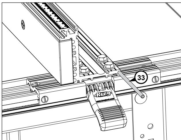
**9** Pour ranger les tiges de décalage (33), faites-les glisser dans la rainure ronde du rebord arrière de l'embase inférieure du profilé du guide (consultez la rubrique **Décalage** de la section **Utilisation de votre guide de table à toupie**).
