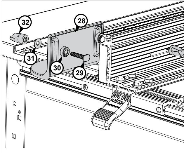
**8** Los aditamentos para esta sección están en el **PAQUETE DE ADITAMENTOS #5**. Ensamble la protección para brocas (28) con pernos en T (29), espaciadores (30), arandelas planas de latón (31) y perillas en T (32). Deslice las cabezas de los pernos en T en la ranura en T del borde superior frontal de la extrusión de la guía, centre la protección en la abertura de la broca para rebajadora y apriete las perillas.
