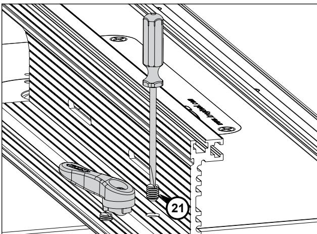
**4** Enrosque dos tornillos de fijación (21) en los orificios que están a ambos lados de la manija de  $\frac{1}{4}$  de giro. Estos tornillos le servirán para cuadrar la guía. (Consulte la sección Alineación y cuadratura de la guía).
