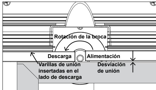
Utilice un trozo de madera que no use para probar la configuración. Si alimenta la broca con la madera y esta corre hasta el extremo principal de la cara de la guía de descarga, la guía está demasiado adelantada y no está retirando suficiente material. Use el microajustador para mover la guía hacia atrás.
