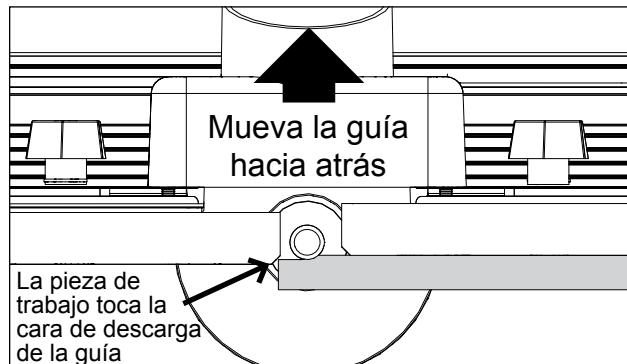
Si la broca hace una ranura en la madera, en el borde posterior, la guía está muy atrás y está retirando demasiado material. Use el microajustador para mover la guía hacia delante.
