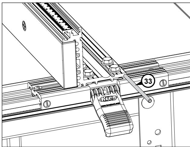
**9** Para almacenar las varillas de unión (33), deslícelas por la canaleta redonda en el borde posterior de la brida de base de la extrusión de la guía. (Consulte Uniones en la sección Uso de la guía de mesa para rebajadora).
